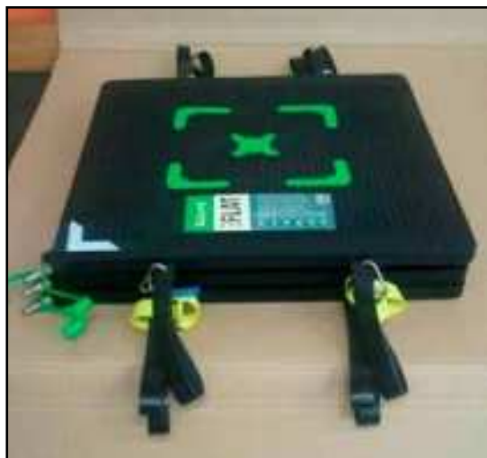
Slika 5.28: Postavitev ploskih/FLAT BAG dvigalnih blazin SAVA v kombinacijo za povečanje dvigalne višine
