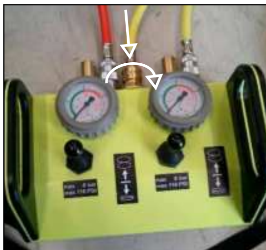
Slika 5.8: Priključitev dovodne cevi na kontroler
