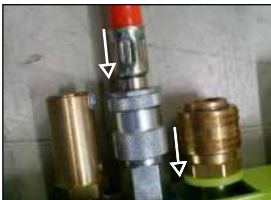
Slika 5.18: Odklop povezovalnih cevi s kontrolerja
