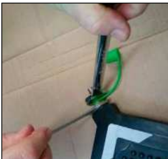
Slika 6.1: Zamenjava vtiča na dvizni blazini SAVA
