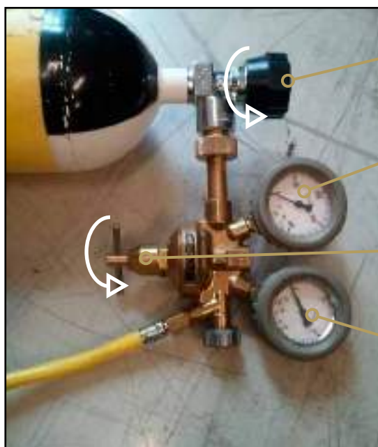
Abb. 5.7: Einstellung des Druckminderventils
