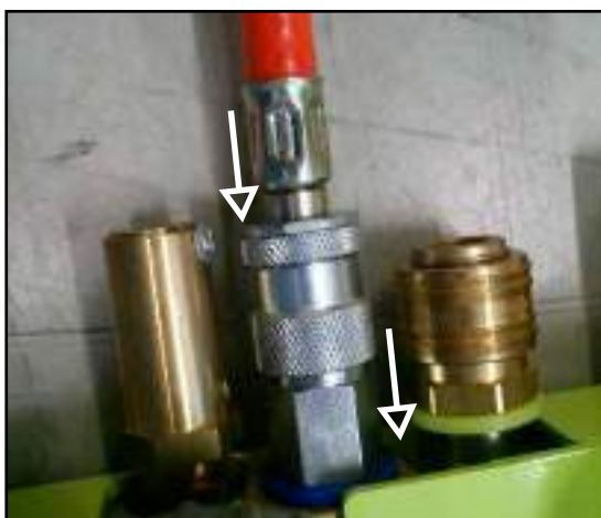
Abb. 5.18: Abtrennen der Verbindungsschläuche vom Steuerorgan
