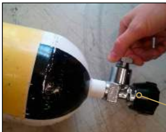
Abb. 5.5: Entfernung des Sicherheitsstiftes vom Druckbehälter
