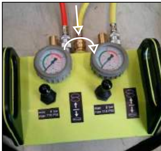
Abb. 5.8: Anschließen des Füllschlauches ans Steuerorgan
