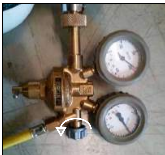
Abb. 5.9: Entlasten des Druckminderventils
