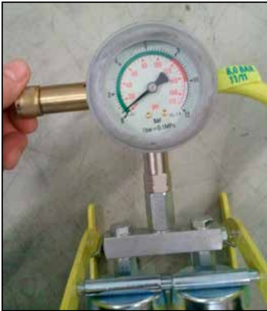
Abb. 5.15: Festschrauben bzw. Abschrauben der Schutzschraube auf dem Sicherheitsventil der Fußpumpe
