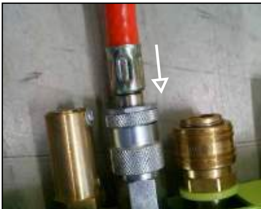
Abb. 5.4: Anschließen von Verbindungsschläuchen an das Steuerorgan
