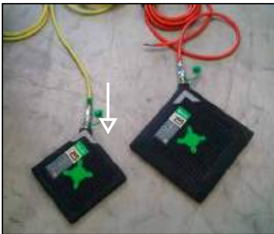
Abb. 5.3: Anschließen vom Schlauch an das SAVA Hebekissen
