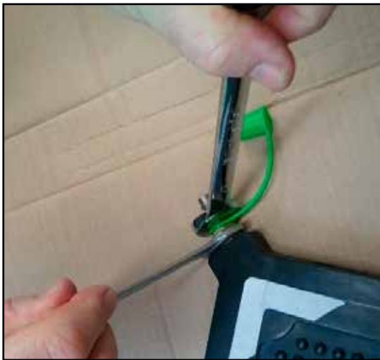
Abb. 6.1: Ersetzen des Anschlussteils am SAVA Hebekissen
