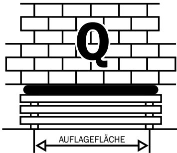
Abb. 5.20: Sicherheitsunterstützung und Auflagefläche
