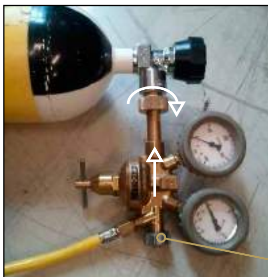
Abb. 5.6: Aufbringung des Druckminderventils
